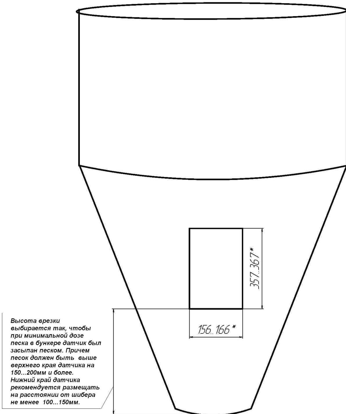
\* В стенке бункера-дозатора выполнить прямоугольный вырез под установку щита влагомера. Размер выреза: в вертикальной плоскости – не менее 357 мм (чтобы щит "провалился"), в горизонтальной плоскости – не более 166 мм (чтобы щит упирался "боковыми краями").
